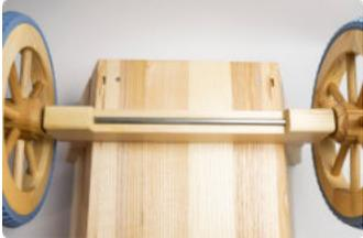
Die Achsführung ist Massivholz und sorgt mit breiten Halterungen für eine sichere Fahrt.
